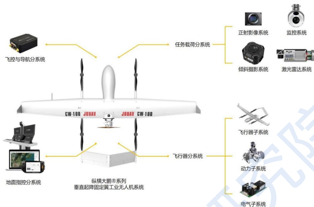
图3 无人机系统构成图示
